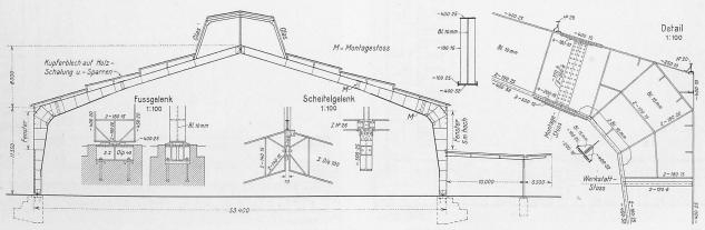
Abb. 2. Hallenquerschnitt 1:500, Einzelheiten des Binders 1:100. — Entwurf und Ausführung der Binder: Preiswerk & Esser, Stahlbau, Basel.
