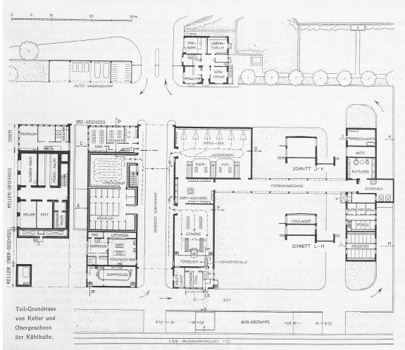
Abb. 2. Grundriss der Schlachthaus-Anlage in Aarau. - Masstab 1:400. (W = Waage.)
