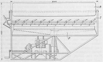
Abb. 1. Luftschrauben-Treibflächen-Bootsantrieb nach System Sohn.
