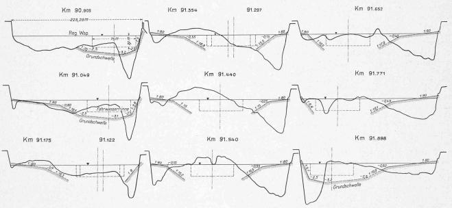
Abb. 8. Zehnfach überhöhte Querprofil-Typen gemäss Ausführungsprojekt 1924 (die Flussohle hat sich inzwischen verändert!). Breiten 1:400, Höhen 1:400.
