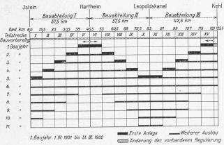
Abb. 3. Der Ausführung zu Grunde liegendes Bauprogramm.
