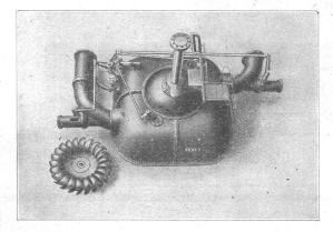
Eine der drei Pelton-Turbinen mit vertikaler Achse und zwei Düsen, des Kraftwerkes Sembrancher (Wallis). Leistung: 5300 PS. – Gefälle: 156 m. – Geschwinzigkeit: 300 Uml./min.
