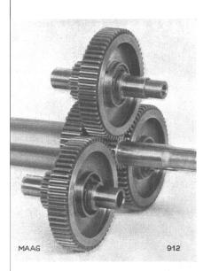
Maag Zahnradgetriebe mit gehärleter und geschliffener Verzahnung zu Aeropian Kompressor für 2000/20000 Umdr./Min.
