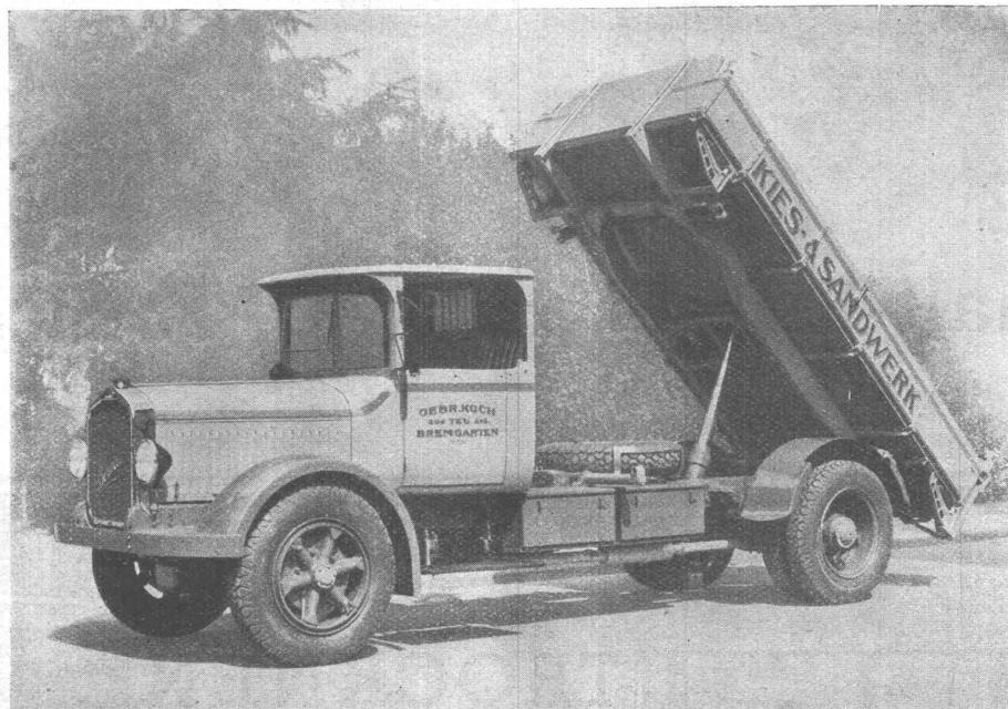
Für grosse Erdaushübe und Baumaterialtransporte sind unsere hydraulischen Dreiseitenkipper unübertrffen. Sie besitzen alle den widerstandsfähigen Berna-Ritzelantrieb mit grosshubigem Benzin- oder Rohölmotor 70 und 80 PS.
