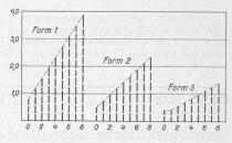
Abb. 4 (links). Luftwiderstandskoeffizienten für Züge nach amerikanischen Versuchen (3 bis 6 extrapoliert),
