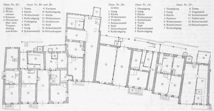
Abb. 1 (oben) Westfront, Abb. 2 (unten) Grundrisse der Häuser Nr. 32 bis 22 in Itingen bei Sissach (Baselland). — Masstab 1:300 (nach Originalen 1:100).
