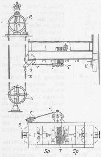
Abb. 29. Schema der Gleitfangvorrichtung.
