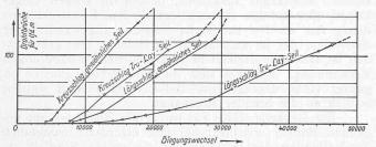
Abb. 20. Zerstörungsverlauf bei verschiedenartigen Drahtseilen.
