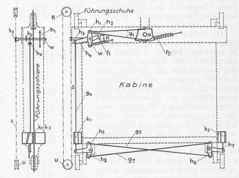
Abb. 28. Schematische Darstellung der Keil-Fangvorrichtung.
