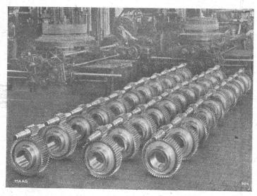
Tramgetriebe mit gehärteter und geschliffener Verzahnung für die Strassenbahn der Stadt Zürich.
