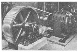
Antrieb eines Kompressors, 130/150 PS.
