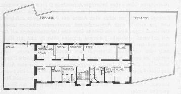
Abb. 3. Studentenheim an der E. T. H. - Grundriss vom I. Stock. - Masstab 1:500.
