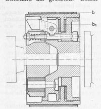
Abb. 2. Fliehkraftbremse.
