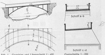
Abb. 1. Grundriss und Längsschnitt 1:400, Querschnit der Bohlbachbrücke bei Habkern, Kt. Bern. — Ing. R. Maillart.
