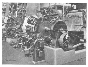
Zeugdruckmaschinenantriebe mit Dreiphasen-Kommutatormotoren.
