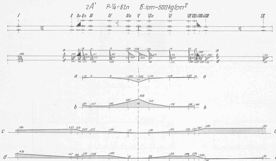
Abb. 11. Stab 2 A, Gruppe I. — Messungen im Längsprofil. Lasche mit Kehlnähten.
