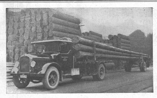
Die Berna-Lastwagen 5-6 t eignen sich vorzüglich für die allerschwersten Arbeiten im Baugewerbe. Dreiseitenkipper, Langholzwagen mit Spillvorrichtung u. Drehschemel. Kräftige Benzin- u. Rohölmotoren; hydraulische Vierradbremse
