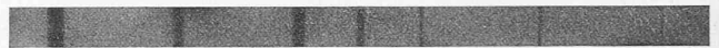
Abb. 2. Fehlererkennbarkeit in Eisen. Durchleuchtete Schichtdicke 15 mm. Bohrungen, senkrecht zur Durchleuchtungsrichtung angebracht, erscheinen als dunkle Streifen. Durchmesser der Bohrungen von links nach rechts: 2,0 mm, 1,5 mm, 1,5 mm, 1,1 mm, 0,7 mm, 0,5 mm und 0,4 mm.
