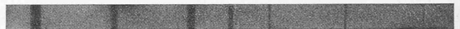
Abb. 2. Fehlererkennbarkeit in Eisen. Durchleuchtete Schichtdicke 15 mm. Bohrungen, senkrecht zur Durchleuchtungsrichtung angebracht, erscheinen als dunkle Streifen. Durchmesser der Bohrungen von links nach rechts: 2,0 mm, 1,5 mm, 1,5 mm, 1,1 mm, 0,7 mm, 0,5 mm und 0,4 mm.
