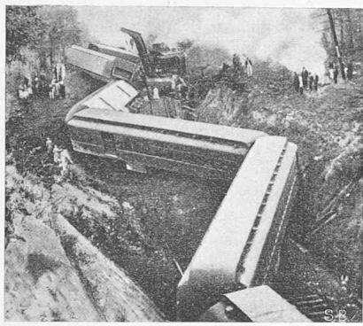
**Eisenbahn-Unfall bei Cartersville in Georgia, U.S.A.** Noch schöner als das Bild des 1931 bei Jüterbog entgleisten Schnellzuges (Bd. 98, S. 114\*) zeigt nebenstehende Photo die Widerstandskraft von Bahnwagen stählerner Bauart gegen Zertrümmerung und Verschachtelung, und damit ihre Vorteile bei Unglücksfällen; im übrigen sei verwiesen auf die bezüglichen Schlussfolgerungen des Internationalen Eisenbahnkongresses in Kairo, die sich auf Seite 23 dieser Nummer finden.
