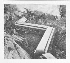
Eisenbahn - Unfall bei Cartersville in Georgia, U.S.A. Noch schöner als das Bild des 1931 bei Jüterbog entgleisten Schnellzuges (Bd. 98, S. 114\*) nebenstehende zeigt Photo die Widerstandskraft von Bahnwagen stählerner Bauart gegen Zertrümmerung Verschachtelung, und damit ihre Vorteile bei Unglücksfällen; im üb-
