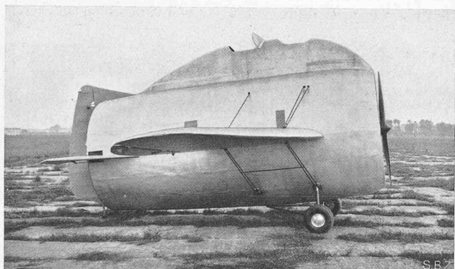
Abb. 1 bis 3. Vorder-, Rück- und Seitenansicht des italienischen „Aereo-tubolare Stipa-Caproni“-Zweisitzers.
