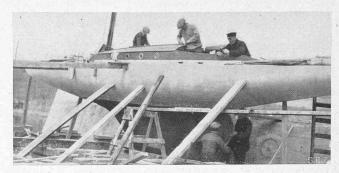
Abb. 2. Ausführung der Deckaufbauten.
