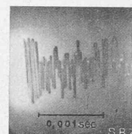
Abb. 20. Druck in der Kavitationszone.
