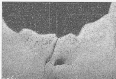
Abb. 26. Mikrophotographie eines korrodierten Messings mit interkristallinen Rissen. 50 fach.
