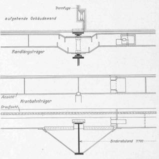
Abb. 6. Längsglieder mit Binderanschluss. - Masstab 1:60.
