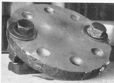
Abb. 1. Erosion an Schrauben durch Tropfenschlag.
