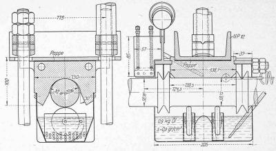
Abb. 4. Versuchslager von Wolff. Quer- und Längsschnitt, Masstab 1:5.
