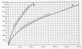
Abb. 8. Zulässige Geschwindigkeit und Bremswege, nach Ing. A. Brüderlin (Zürich). Kurve A bei nasser, glatter Fahrbahn, d. h. einem viermal niedrigern Reibungs-Koeffizienten zwischen Reifen und Fahrbahn, als bei trockener Strasse (Kurve B); unter Einrechnung einer Reaktionszeit von 1 sec für Einleitung der Bremsung.
