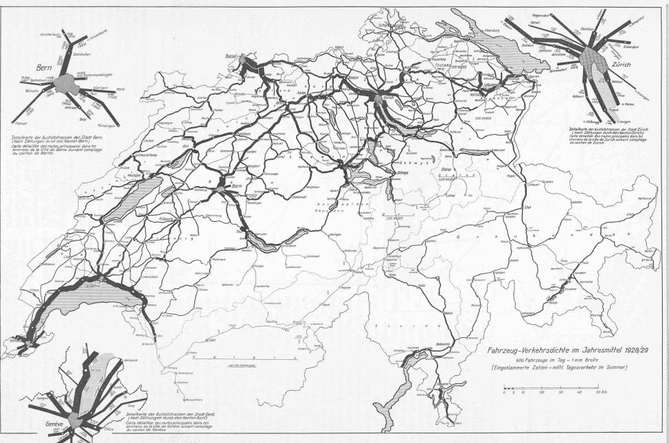
Abb. 5. Verkehrsdichte des schweizerischen Strassennetzes gemäss Zählung der im Tag verkehrenden Fahrzeuge 1928/29 (Jahresmittel). — Masstab 1:1250000.
