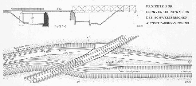
Abb. 22. Fernverkehrstrasse Bern-Olten. Generelles Projekt des Ingenieurbureau Losinger & Cie., Bern (allgem. Uebersichtspläne siehe nächste Seite). Verdoppelung der bestehenden Unterführung nördlich von Zollikofen. — Lageplan 1:1500, darüber Querschnitt A-B, im Masstab 1:500.
