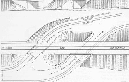
Abb. 14. Verdoppelung (statt Erweiterung) einer bestehenden Unterführung bei Km. 30,900 der Hauenstein-Strasse Basel-Olten. — Masstab 1:600.
