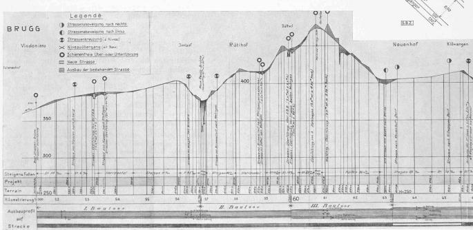
Abb. 62. Fernverkehrstrasse Brugg-Innlauf-Neuenhof-Zürich. — Ing. A. Frick, Zürich. — Längenprofil der 12 km langen Neubaustrecke, 1:80000 (Höhen 1:3000).
