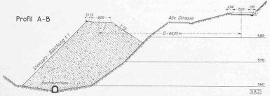
Abb. 15. Querschnitt A-B der Strassenkehre in Abb. 16. - Masstab 1:1000
