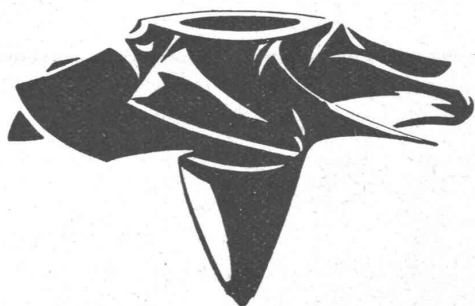
Laufwerk von 5 m Durchmesser und 26 t Gewicht, zu einer modernen Propeller-Turbine von 15000 PS Leistung.
