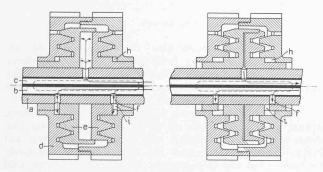
Abb. 1. Schema der Oeldruck-Reibungskuppplung S. L. M. Winterthur. Links geöffnet, rechts geschlossen.
