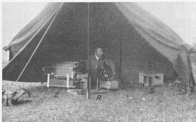
Abb. 3. Beobachtungszelt für Zeitmarkierung, Registrierung und Seismometer.
