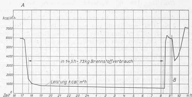
Abb. 4. Regulierversuch (Nachtbrand) an einem Kessel von 33,5 m 2 Heizfläche. A nach 10 Stunden Brenndauer ohne Entschlacken, Teilfüllung aufgegeben und Luftdrosselklappen geschlossen.
