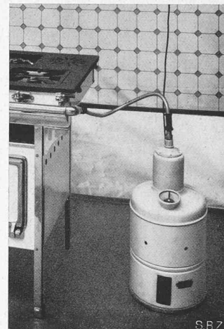
Abb. 1 u. 2. Schema und Ansicht des „Aerogaserzeugers“.
