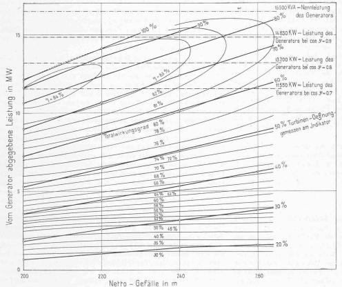
Abb. 9. Leistungs- und Wirkungsgrad-Charakteristik an der Turbinen-Generator-Gruppe 3 in Rempen.
