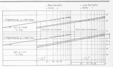
Abb. 5. Flügelmessungen in der Druckleitung. Logarithmische Darstellung der Wassergeschwindigkeit in Abhängigkeit des Faktors  $1-(r/ra)^2$  zwecks Extrapolation der Geschwindigkeitskurve in Nähe der Rohrwand.
