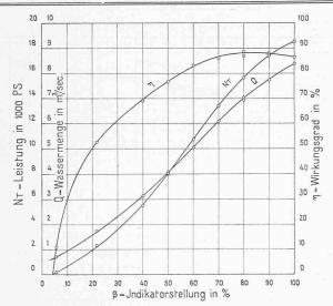
Abb. 1. Abnahmeversuche an Turbine 4 in Siebnen, Sept.-Okt. 1925. Oeffnungscharakteristik für  $H=192~{\rm m},~n=500~{\rm Uml/min}.$
