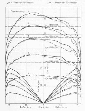
Abb. 4. Flügelmessungen nach System Dufour in der Druckleitung. Geschwindigkeitskurven, aufgetragen über dem Rohrradius.
