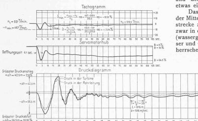
Abb. 3. Regulierversuche an der Turbine 2 des Kraftwerkes Siebnen, vorgenommen im August 1928. Plötzliche Belastung von Leerlauf auf Halblast.
