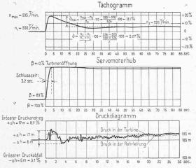
Abb. 2. Regulierversuche an Turbine 2 in Siebnen, Aug. 1928. Plötzliche Entlastung von Vollast auf Leerlauf. Betriebszustand vor der Abschaltung:
