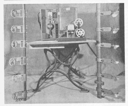
Abb. 3. Stoppani-Ringflügel und ringlose Ott-Flügel mit Bandchronograph.
