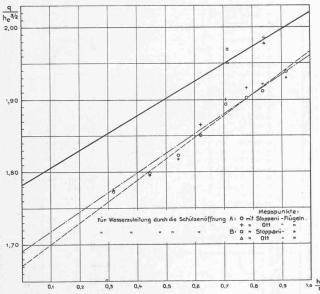
Abb. 6. Ausgleichung der Flügelmesspunkte durch eine Gerade nach der Formel Rehbock 1929 (voll). Ausgleichgerade: Strichpunktiert Ott, gestrichelt Stoppani.
