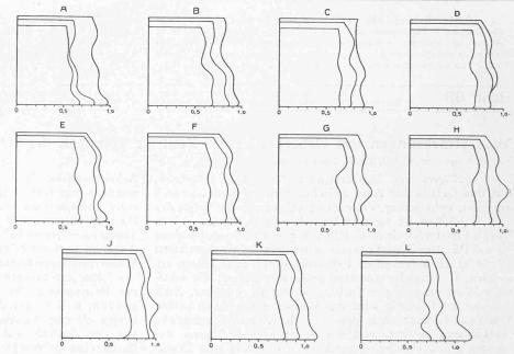
Abb. 5. Geschwindigkeitspolygone in den elf Vertikalen A bis L (vergl. Abb. 4) für die Wassermengen 5,66 m³/sec, 4,40 m³/sec und 3,34 m³/sec.
