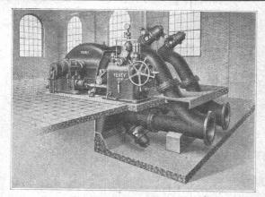
Eine der Pelton-Turbinen des Sernf-Niederenbachwerkes. 4 Düsen. – 7400 PS unter 215 m Gefälle. – 500 t/min. Wasserturbinen aller Systeme
