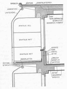
Konstruktions-Einzelheiten. - Masstab 1:60.
