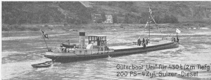
Abb. 75. Motor-Güterboot für 450 t, nach Entwurf von Schiffbau-Ingenieur Ad. J. Ryniker, Basel. Rotterdam-Basel (830 km) 90 bis 100 Fahrstunden; Reisedauer 6 bis 7 Tage, Bedienung 2 bis 3 Mann.
