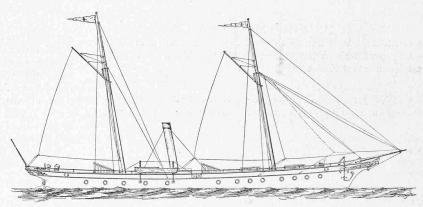
Abb. 69. Dampf-Segeljacht auf dem Genfersee, gebaut 1883 von Escher Wyss & Cie., Zürich [9. Aug. 1884]. Länge ü. A. 38,5 m, Breite 5,0 m, Déplacement 100 t; 250 PSi, n 135, v 24 km/h. — Das Schiff fährt heute als "Cadenabbia" (mit Dieselantrieb) auf dem Comersee, als besonders seetüchtig beliebt.
