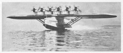
Abb. 76. Dornier-Flugschiff Do X; 7200 PS; es trägt in 6¹/2 Stunden 6500 kg Nutzlast 1200 km weit. Gebaut auf der Dornier-Werft in Altenrhein, Schweiz.
