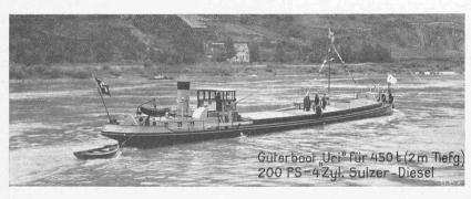
Abb. 75. Motor-Güterboot für 450 t, nach Entwurf von Schiffbau-Ingenieur Ad. J. Ryniker, Basel. Rotterdam-Basel (830 km) 90 bis 100 Fahrstunden; Reisedauer 6 bis 7 Tage, Bedienung 2 bis 3 Mann.
