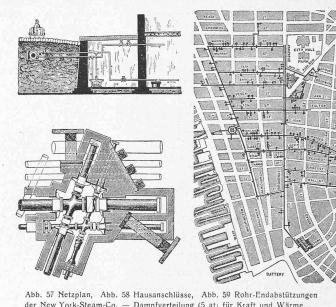
der New York-Steam-Co. - Dampfverteilung (5 at) für Kraft und Wärme, mit Kondenswasser-Rückleitung. ["S. B. Z." vom 26. April 1884.]
