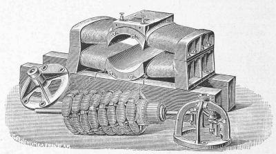
Abb. 55. Umkehrbare dynamo-electrische Maschine von Ing. Emil Bürgin, Basel. Diente mit 2,5 bis 8 PS zur Speisung der Bürginschen Bogenlampen. [17. Juni 1882.]
