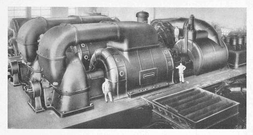
Abb. 56. Dampfturbinen-Aggregat für 160000 kW, geliefert 1927 von Brown, Boveri & Co., Baden (Schweiz) für die Zentrale Hellgate in New York. [Beschreibung siehe "S. B. Z." Band 89, Seite 79.]
