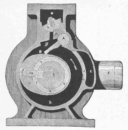
Abb. 54. Hudsons-Rotations-Dampfmotor. [1883.]
