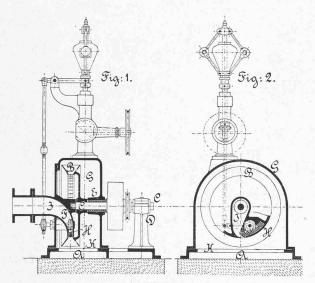
Abb. 45. Mechanisch regulierbare Girard-Turbine "für hohe Gefälle". — 1 : 20.  $H=85~{\rm m},~\varnothing$  480 mm, Q=5 1/sec, N=4 PS,  $\eta=71^{\circ}/_{0}$ . [16. Febr. 1884.]
