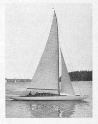
Abb. 36 und 37. 40 m2-Schärenkreuzer (Regattaboot) aus Eisenbeton mit Sika-Zusatz; Wandstärke 10 mm. - Ing. Yberg, Ramvik, Schweden. d. h. nur 300 bis 400 kg mehr als Holzbau. [Beschreibung folgt 1933.]
