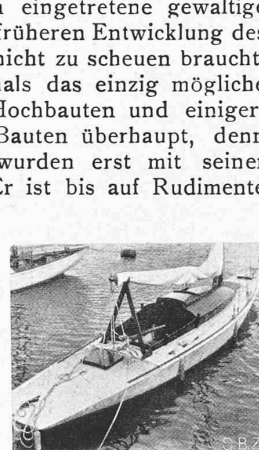
Abb. 36 und 37. 40 m 2 -Schärenkreuzer (Regattaboat) aus Eisenbeton mit Sika-Zusatz; Wandstärke 10 mm. — Ing. Yberg, Ramvik, Schweden. — Gewicht 1500 kg, d. h. nur 300 bis 400 kg mehr als Holzbau. [Beschreibung folgt 1933.]
