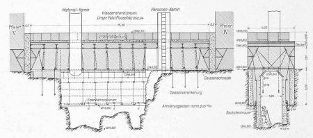
Abb. 42. Unterfangung einer Caissonschneide mit Eisenbeton am Stauwehr Augst-Wyhlen. — 1:200. Entwurf und Ausführung A. G. Conrad Zschokke, Genf. [Aus der "S. B. Z." vom 12. April 1913.]
