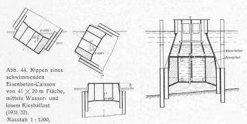
Patent Grün & Bilfinger. ["S. B. Z." 26. Dez. 1931.] Abb. 45. Querschnitt 1:800. Pfeilergründung der Eisenbahnbrücke über den Kleinen Belt, Dänemark.
