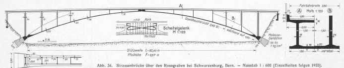
Gesamtlänge 103 m, überbrückte Fläche 420 m², Eisenbeton 0,74 m³/m², Bauzeit 72 Arbeitstage, Baukosten 82700 Fr. d. h. knapp 200 Fr./m² überbrückter Fläche.
