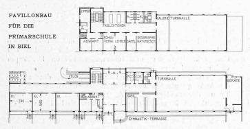
Abb. 29. Erdgeschoss und Obergeschoss der Pavillonschule Biel. — 1:800.
