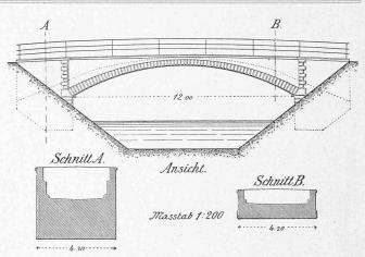
Abb. 33. Betonbrücke Zurlinden in Aarau, 12 m weit, Pfeil 2 m, Scheitel 50 cm. Gewölbebeton 1:6, Kubatur 80 m³; durch 65 Mann in einem Tag betoniert. Nach Entwurf von Prof. L. Tetmajer, Direktor der E. M. P. A. Zürich [1884].
