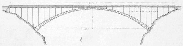
Abb. 38. Schwarzwasserbrücke bei Schwarzenburg, Bern. Eisenkonstruktion 430 t, Baukosten 279 Fr./m². Erbaut durch G. Ott & Cie. in Bern. 4 : 1000. [1884].
