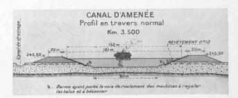
Abb. 3 bis 5. Querschnitte des Kanals. Masstab 1:3000.
