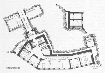
Abb. 7. Erdgeschoss-Grundriss (Arbeitsräume) und Schnitt durch den Ostflügel. — Masstab 1:400.
