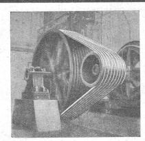
Antrieb eines Kompressors, 125 PS.
