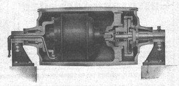
in offener oder staubund spritzwasserdicht gekapselter Bauart
