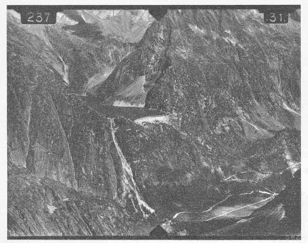
Abb. 33. Stausee Gelmer der K. W. O. und Umgebung, aus Westen, von Station links der 897,07 m langen Basis Aerlengletscher, 2617,8 m ü. M. — Aufnahmeaxe normal zur Basis und um 12 gr. abwärts gekippt. Phototheodolit Nr. 31, Brennweite 237 mm. (Cliché in Naturgrösse der Platte).
